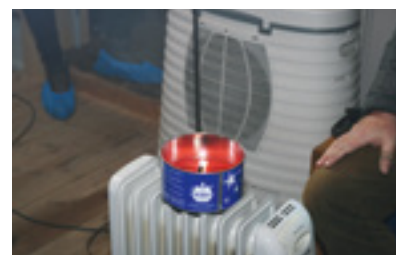
Fakkelen slokket 1,56 minutter etter utløsning av anlegget.
