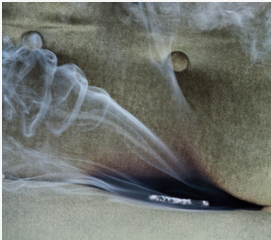
Sigaretter som havner ned i sprekker i møbler kan resultere i brann. Særlig møbler med stopp av polyuretanskum er spesielt utsatt. Slik stopp er vanlig i alle møbler i dag.
